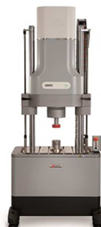
図 疲労試験システム
