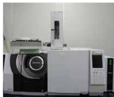
代理汚染物質を測定するGC/MS/MS
