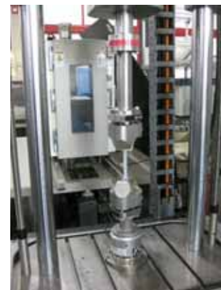
図 疲労試験状況
