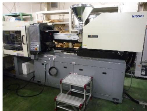
電気式高性能射出成形機 NEX-80IV
