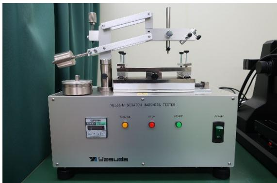
図1 鉛筆引っかき硬度試験機（機械法）
