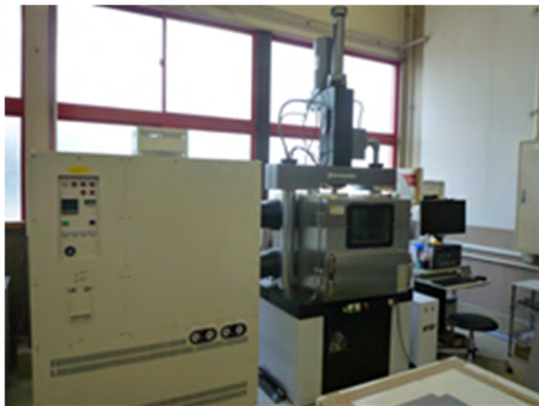
高速パンクチャー試験機 HTS-PX 形 (株式会社島津製作所製)
