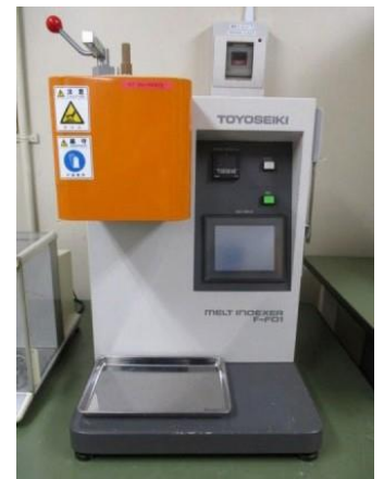
MVRを測定するメルトインデクサー
