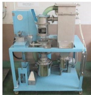
粉砕したボトルとラベルを選別するための風力選別装置
