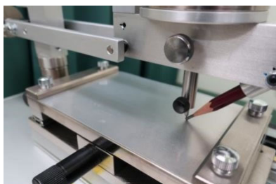
図2 試験状況 (機械法)
