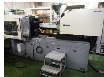
電気式高性能射出成形機 NEX-80IV
